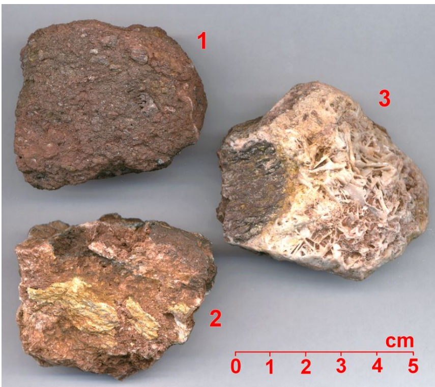
Abb. 9: Durch Geländeregulierung hervortretende dichte Rotverwitterung mit starker Vermischung von Ganggesteinen, die danach auffällig rote, wachstumshemmende Bodenflächen bildet. Der Fundpunkt vom 31.10.1993, als Aufschluss Nr. 2 in der Karte Abb. 2 gekennzeichnet, ist heute wieder verwachsen.
