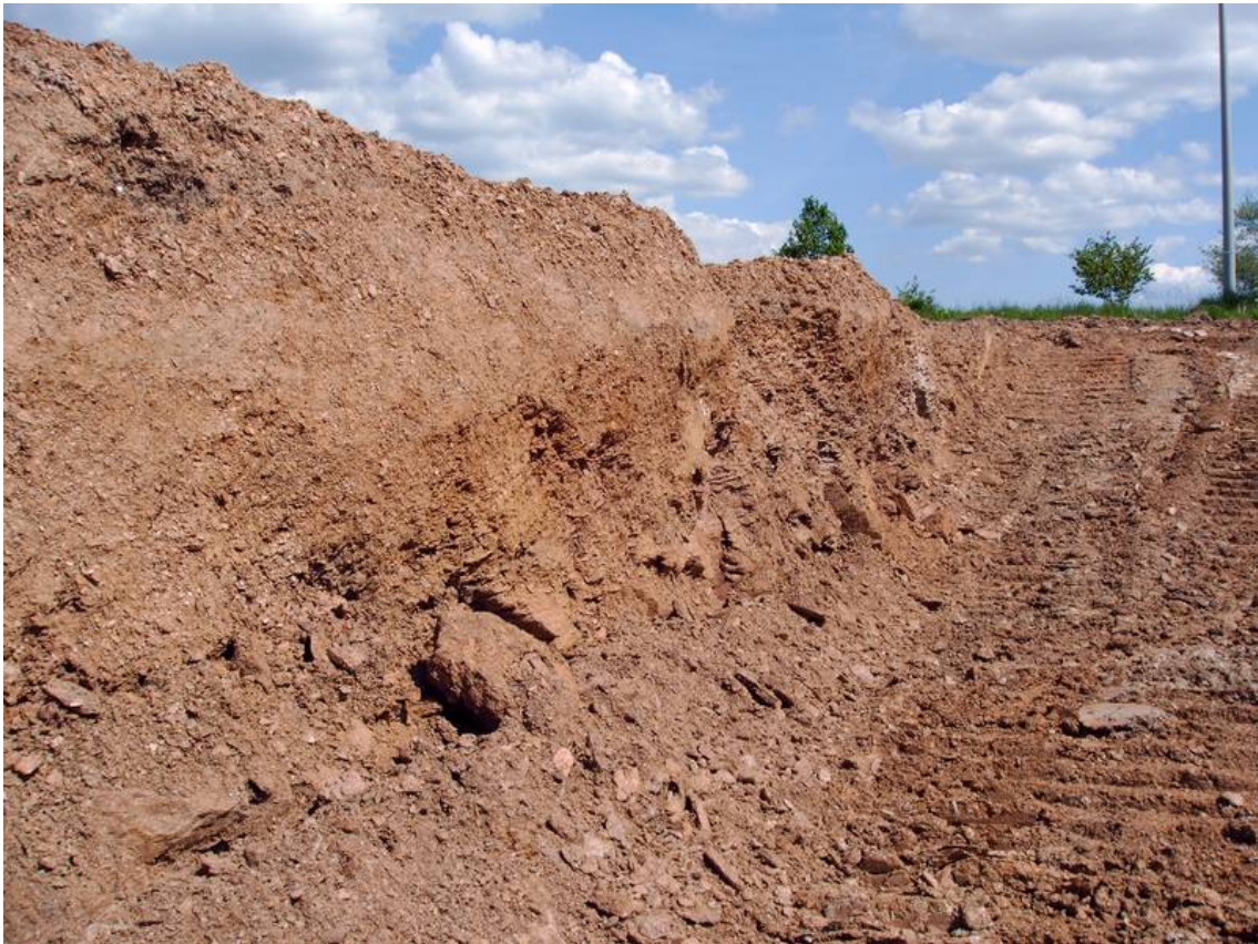
Abb. 12: Aufschlusspunkt Nr. 7 in Abb. 2; stark verwitterter Para-Biotit-Zweifeldspatgneis mit schwachen Partien reliktsicher silbrig-graugrün gebleichter und violettroter Rotverwitterung, Profilhöhe vorn im Bild bis 1,20 m (Abbildungen 12 - 17 zur Zeit der 2. Geländeregulierung, Foto: 11.05.2008)
