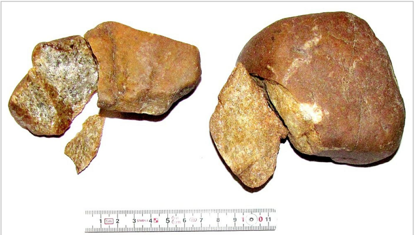
Abbildung 4: Aufgeschlagene eisenumkrustete Quarzite zur Feststellung des Durchdringungsgrades der Eisenminerale in das Geröllinnere. Links ein größeres und rechts ein feinkörnigeres Exemplar. Die Fe-Kruste des gerundeten Quarzites (rechts) ist erst nach dem abschleifenden Gletschertransport gebildet worden. Vergrößerungen der Bruchflächen sind in den Abbildungen 5 a bis e dargestellt. Fundort: Bereich Industrie- und Gewerbegebiet Freiberg Ost. Höhe des Untersuchungsgebietes 400 - 410 m NN.
